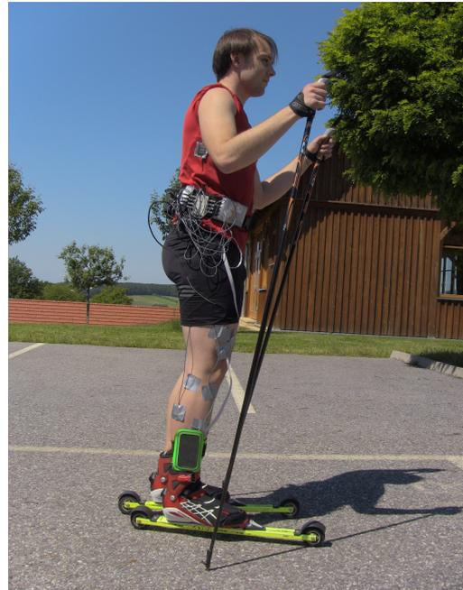
Abbildung 5: Applizierung der IMU, EMG-Elektroden und der Datalogger
