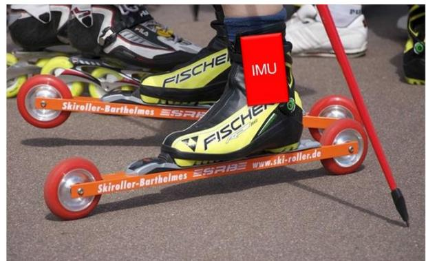
Abbildung 3: Positionierung des Beschleunigungssensors am Fuß
