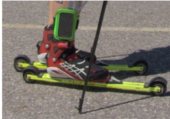
Abbildung 28: Positionierung des Smartphones welches als IMU dient (grüne Halterung)
